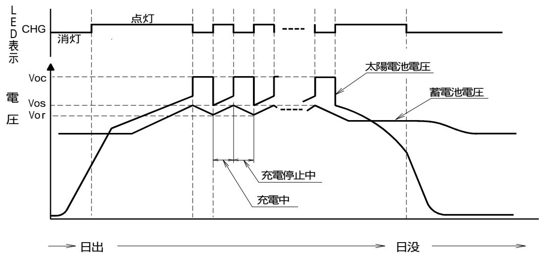
日の出とともに太陽電池電圧が上昇し、充電制御回路が作動を開始し充電スイッチがONとなります。
